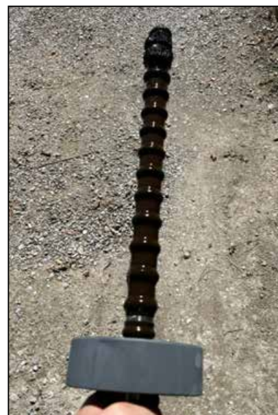
La sonda dopo il lavaggio. Infatti, quelle che si vedono sono impurità ferrose che si manifestano in seguito alla pulizia dell'impianto
